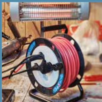
**Stromfluss erzeugt Wärme. Je leistungsstärker die Geräte, desto höher der Hitzestau in der Kabelrolle. Es droht ein Brand.**
